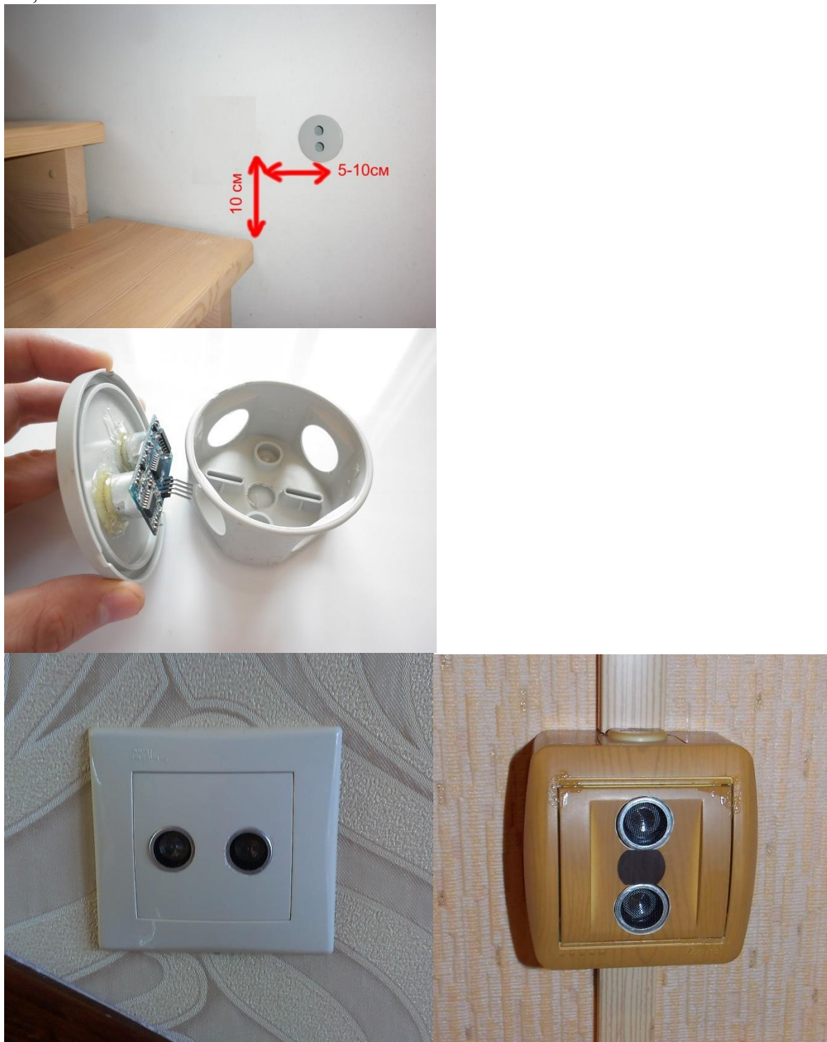
Рис. 5. Рекомендуемая установка датчиков
